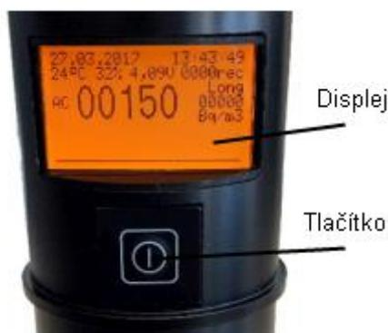
Po stisku tlačítka při vypnutém displeji se zobrazí úvodní displej. Zde se zobrazují základní údaje o sondě, pro uživatele je zajímavá informace o tom, zda je zapnuté/vypnuté měření (Measure ON/OFF), případně označení sondy (většinou výrobní číslo) – sn: xxxxxxxxxx.
